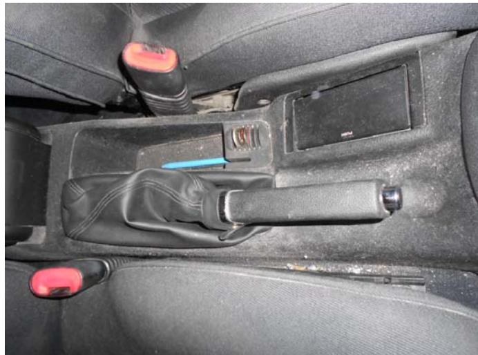
Soulevez le levier du frein à main (1a) et desserrez l'écrou (1b) (clé de 10) de réglage de tension des câbles frein à main.
