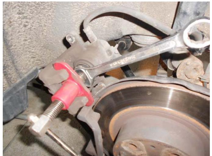
Vérifiez l'épaisseur du disque cote MINI 9 mm, si inférieure changer les 2 disques
